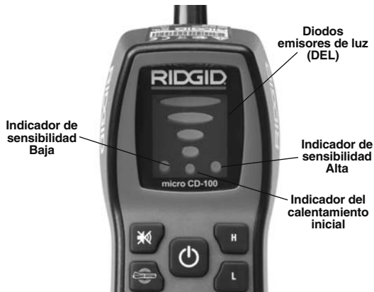
Figura 3 – Pantalla del micro CD-100
