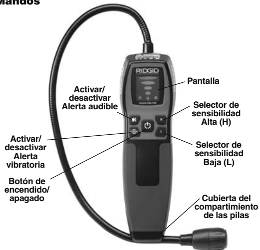
Figura 2 – Piezas y botones del micro CD-100
