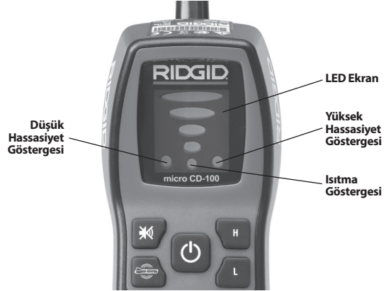
Şekil 3 – micro CD-100 Ekranı
